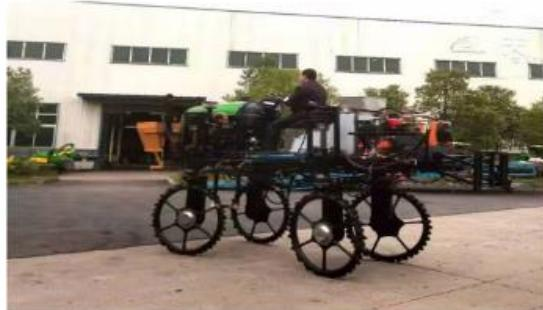
针对水田植保机沉陷量大使得易滑转和过埂困难，田间转向和行距不适当导致压苗严重等问题，中国农业工程学会青年科技工作委员会蒋蘋教授团队研发了四轮独立驱动、车身自动调平、轮距及地隙可变，可进行四轮转向和横向平移的参数自适应高地隙动力平台，成果已在企业转化，并获湖南省技术发明二等奖。
