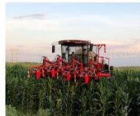
该机具采用自走式高地隙底盘，行走驱动桥通过行走液压马达驱动，能实现无级变速，可靠性高；采用柔性夹持式玉米去雄调控技术，通过光电传感器感应，利用编程控制器控制比例阀，最终使去雄作业部件处于最佳作业位置。
