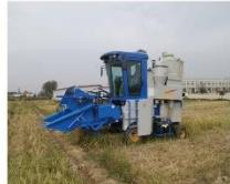
该机具采用动力自净割台与自适应无残留脱清收获技术，具备收割、脱粒清选、自动清洁、称重、溯源包装等一体化功能，解决了收获效率低、自净能力差、脱净率低、破损率与损失率高等关键问题。
