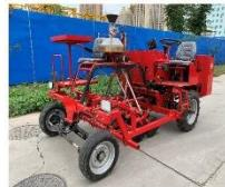
该机具采用的锥体均格式排种器具备匀量旋转排种技术可保证在行长内将所有种子排空，小区间不发生混杂；电力驱动对扇式旋转分种头具备的匀量分种技术可保证将份量的小麦种子均分至各个播种单元，保证各行播量一致性。
