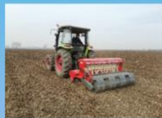
图3.3 自主研发的宽苗带播前镇压小麦播种装备
