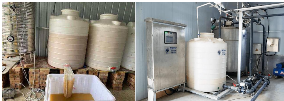
目前现有技术采用保温发酵,这就导致杂菌污染严重,因为这些简易现场发酵装备并没有对水体、培养基进行灭菌处理,导致目标菌无法快速占据生态位。此外,设备运行中需要人为的进行调控,整个过程很繁琐。
